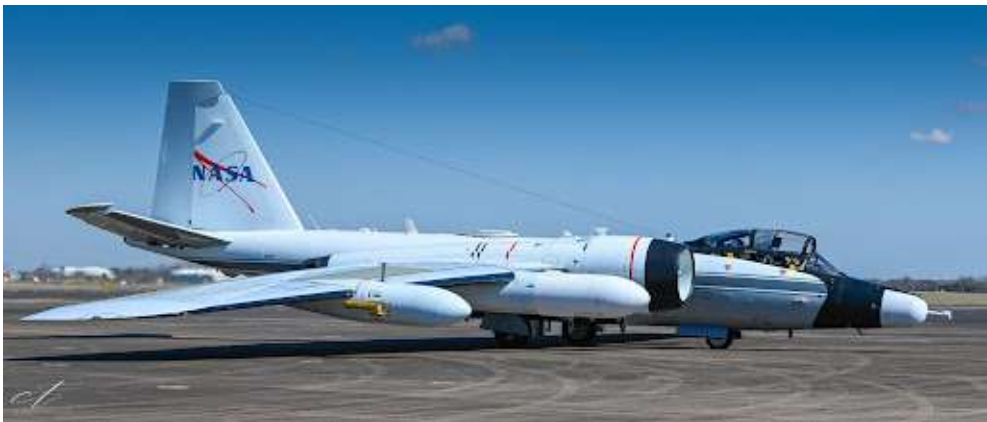
Ilustración 2. Avión de la NASA WB-57, con el sensor de partículas en la punta del fuselaje 4 .
